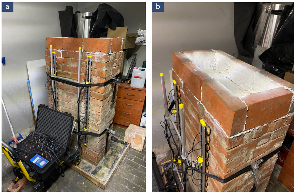
Rys. 5.1. Sztucznie zawilgocony mur ceglany w warunkach laboratoryjnych: (a) widok całego stanowiska badawczego, (b) górna część muru
